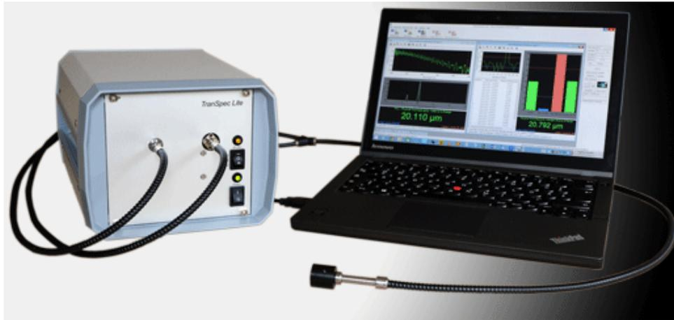
Die **TranSpec Lite** Schichtdicken-Messgeräte benutzen die sogenannte Weißlicht-Interferenz zur berührungslosen und zerstörungsfreien Messung von transparenten Einzel- und Doppelschichten im Bereich von ca. 0,8 bis 120 Mikrometer (je nach Modell). Die Messgeräte sind speziell für manuell ausgeführte und einfach zu handhabende, aber dennoch hochpräzise Dickenmessungen im Labor und in der Qualitätssicherung entwickelt worden.
